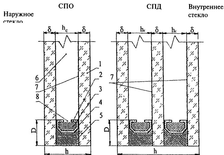
1 — стекло; 2 — дистанционная рамка; 3 — влагогодотитель; 4 — нетвердеющий герметик; 5 — отверждающийся герметик; 6 — воздушная прослойка (межстекольное расстояние); 7 — рекомендуемые варианты расположения низкоземиссионного покрытия в случае его применения; 8 — дегидрационные отверстия;  $\delta$  — толщина стекла;  $h$  — толщина стеклопакета;  $h_c$  — расстояние между стеклами;  $D$  — глубина герметизирующего слоя
