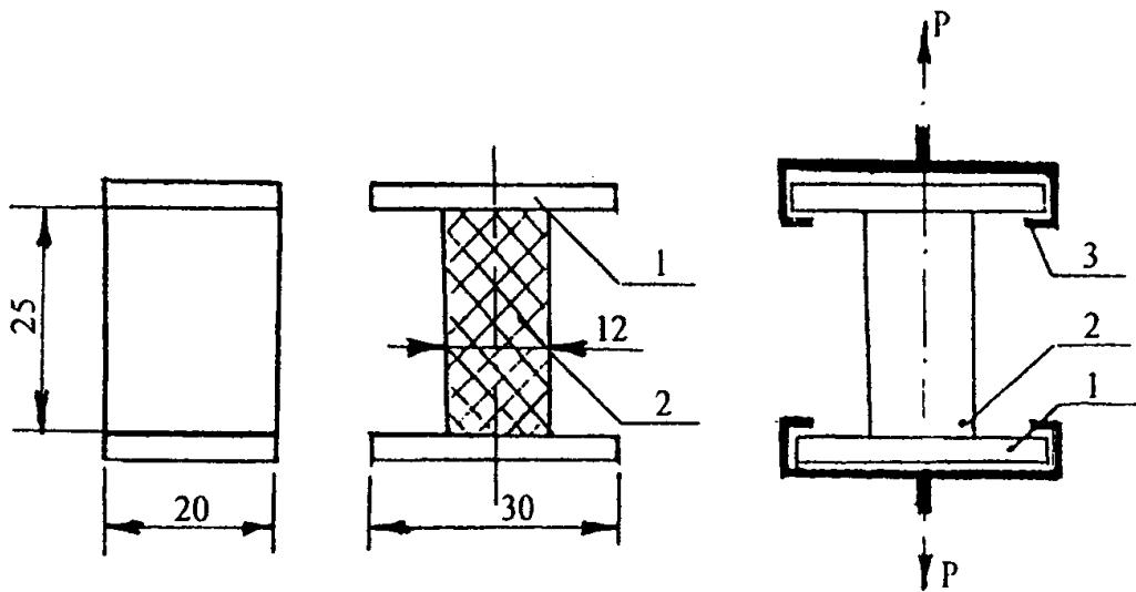
*1 — стекло; 2 — герметик; 3 — захват разрывной машины или приспособления*
